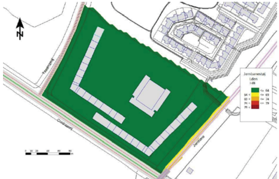
Figur 15: Støjpåvirkning fra jernbane.
