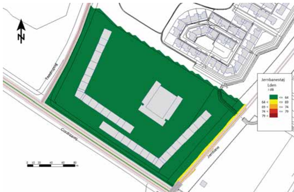
Figur 5: Resultat af beregning af jernstøj på terræn. Beregningshøjde: 1,5 m over terræn.
