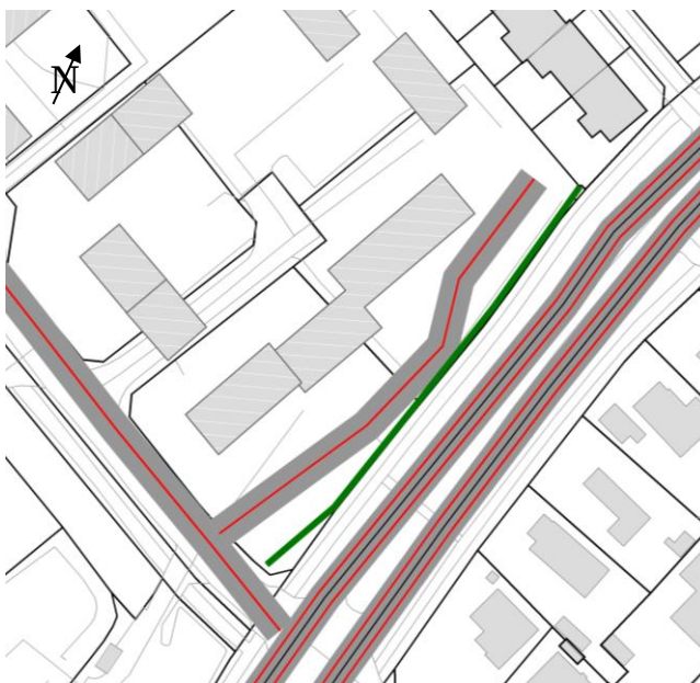
Figur 7: Illustration af oplæg til placering af støjskærm
