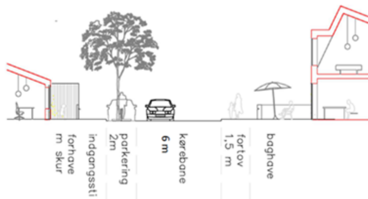
Principtegning for tværprofil af de lokale fordelingsveje i lokalplanområdet.
