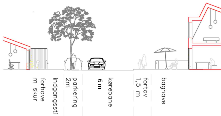
Figur 6. Principielt vejsnit fra det foreløbige materiale (01.04.2025) tilpasset en hastighed på 30 km/h
