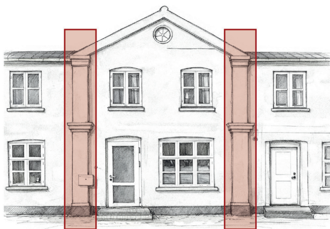
Hovedgaden 26 eksempel på pilastre
